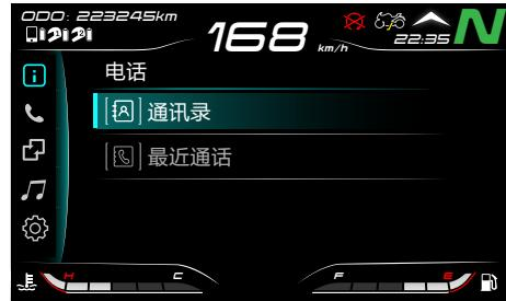
**注意：使用仪表电话功能前，必须正确的进行设备连接，将手机、头盔与仪表进行连接。**
