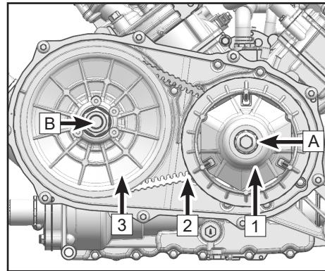
从动轮（3）安装在变速箱输入轴（B）上并提供两项功能，作为主动轮的从动轮，提供扭矩传感件切换传动比。传动皮带（2）是连接发动机和变速箱离合器皮带轮的非常重要的V型皮带。
