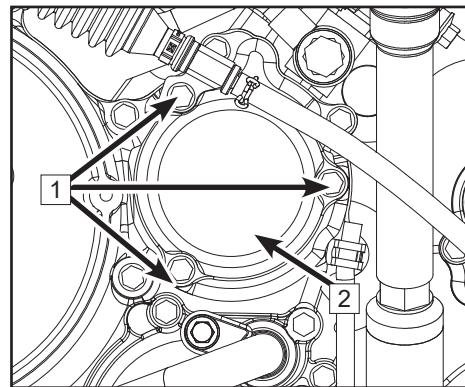
1 | 发动机机油螺栓 | 2 | 滤清器盖
