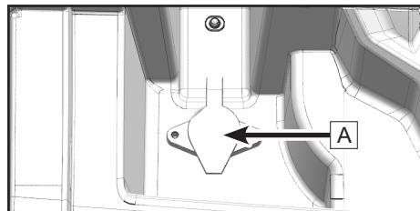
A 开关座 , 绞盘电源端口
