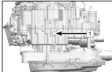
1 | 发动机机油放油螺栓
