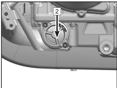
拆下加油口螺塞及 O 型密封圈 [3]；
