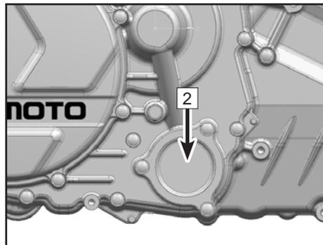
拆下加油口螺塞<sup>3</sup>；
