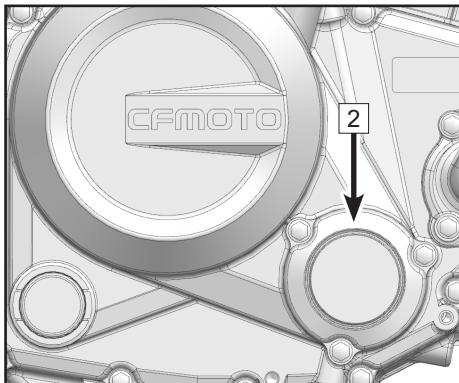
拆下加油口螺塞 **[3]**；
