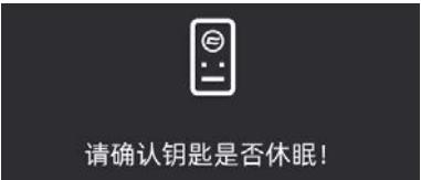
这种情况下用户携带蓝牙钥匙重新进入允许启动区域，弹框将自动消失。出现弹框提醒时，如果 60s 后钥匙还是处于断连状态，车辆将自动下电。（这种场景是为了防止用户停车时只进行了熄火没有下电就携带钥匙离开，导致整车亏电）
