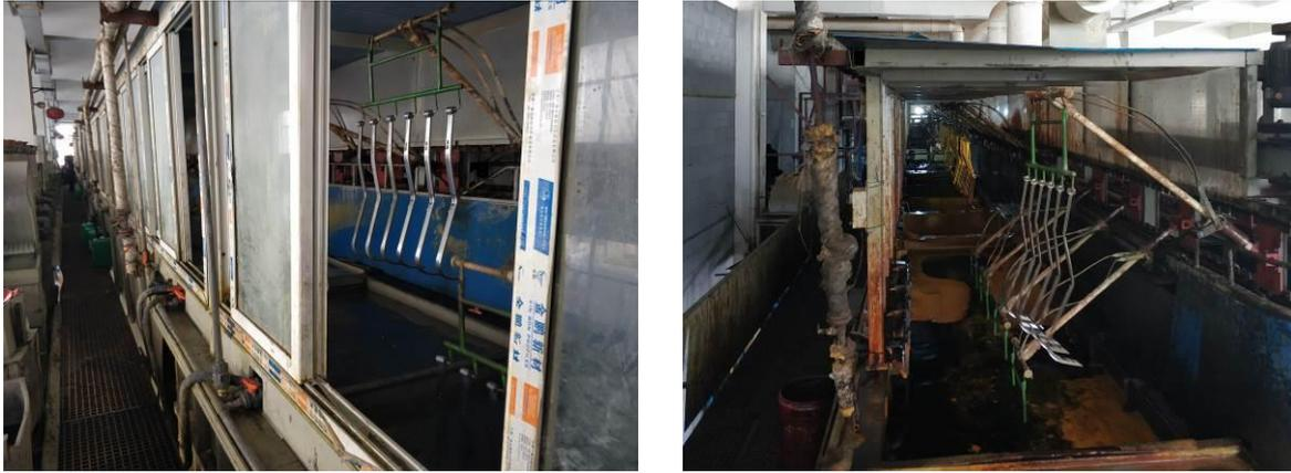
图 3.3-6 电镀件输送装置
